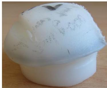
FIGURE 1.4.: Lopin en GHR 8110 déformé après l'éjection
