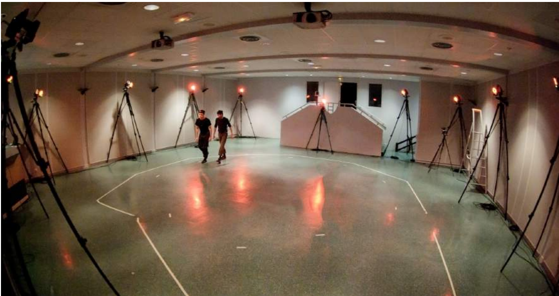
Figure 2.1 – Dispositif expérimental pour la capture de mouvement de deux acteurs dans la salle Métivier (du centre IRISA/INRIA Rennes). Les caméras du système de capture Vicon MX-40 sont disposées tout autour de la salle. On aperçoit le marquage de la zone de capture au sol.
