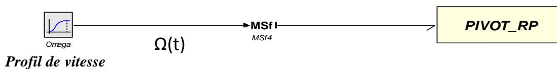
Figure III.10 - Modélisation bond graph de la motorisation en tant que source de vitesse
