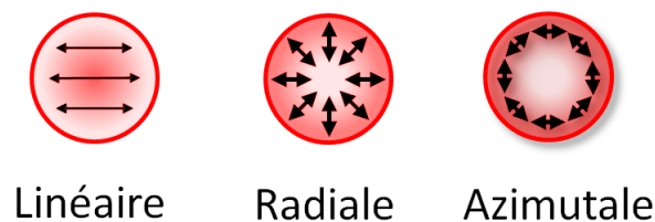
FIGURE 3.4 – Représentation schématique de la distribution d'intensité et de l'orientation locale du champ électrique pour des états de polarisation linéaire, radiale et azimutale.
