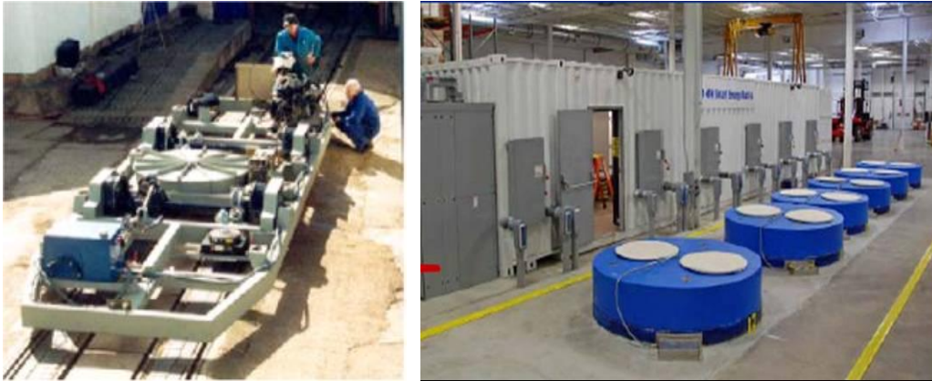
Fig 1-29 : Volant d'inertie du tramway de Bristol et ferme de volants de 1 MW Beacon Power
