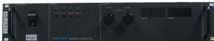
Fig 5-9: Face avant de l'alimentation Xantrex XKW 300V 10A
