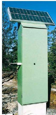
Fig 1-43 : Prototype couplant PV et pile à combustible
