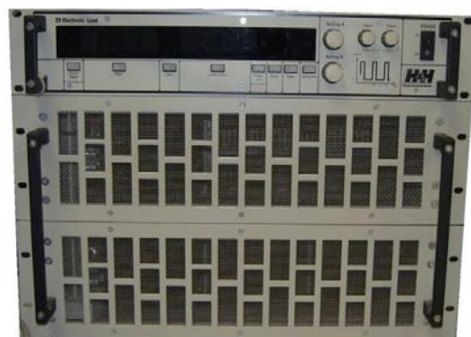
Fig 5-20: Charge électronique H&H pour l'émulation de l'électrolyseur
