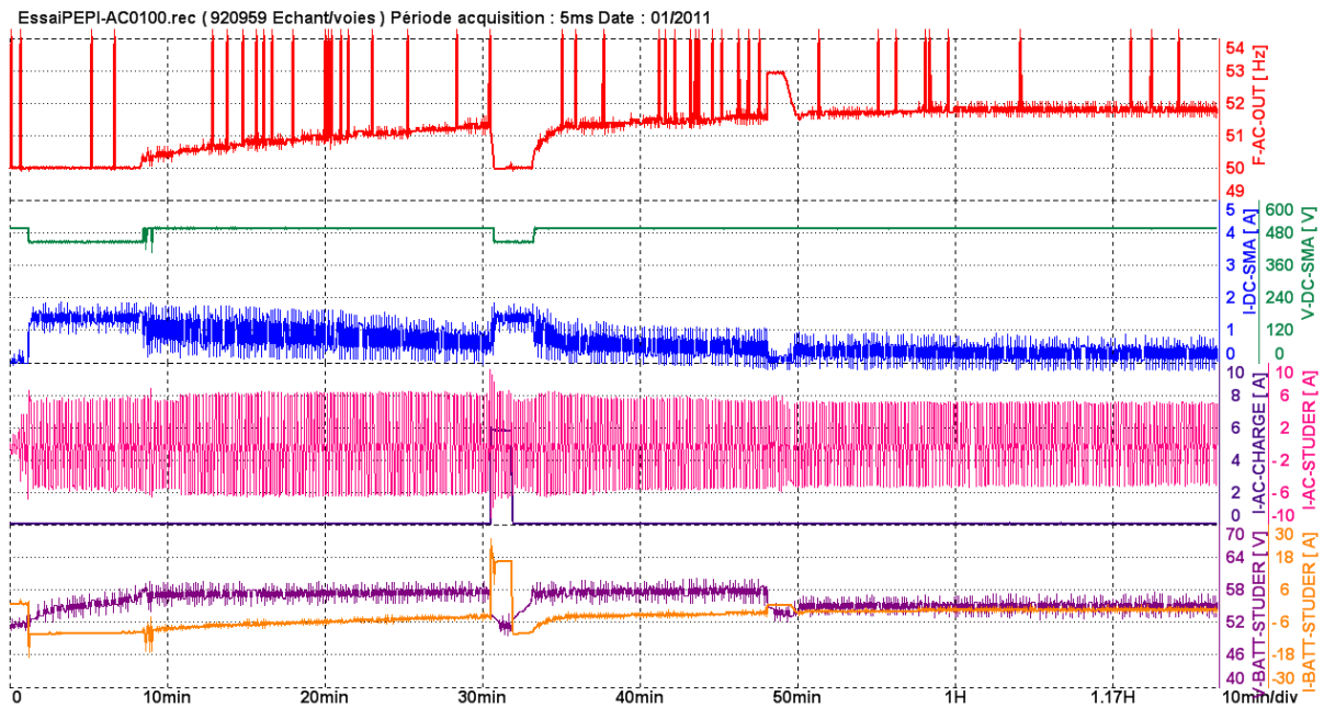
Fig 5-74: Fonctionnement linéaire de la fréquence sur les deux onduleurs
