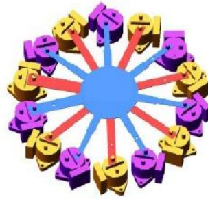
Fig 5-7: Bus continu de l'armoire d'interconnexion
