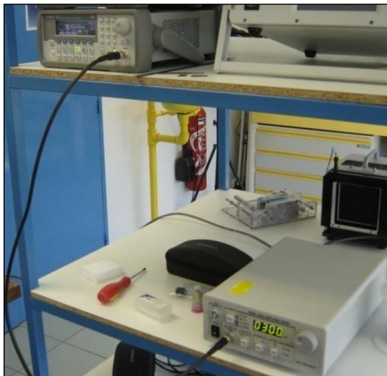
Figura 4-26 – Laser diodo controlado pelo gerador de função
