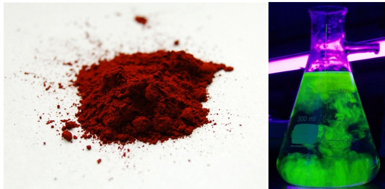
Figure 124 : Poudre de fluorescéine et couleur émise lors de l'excitation de la fluorescéine mélangée dans l'eau
