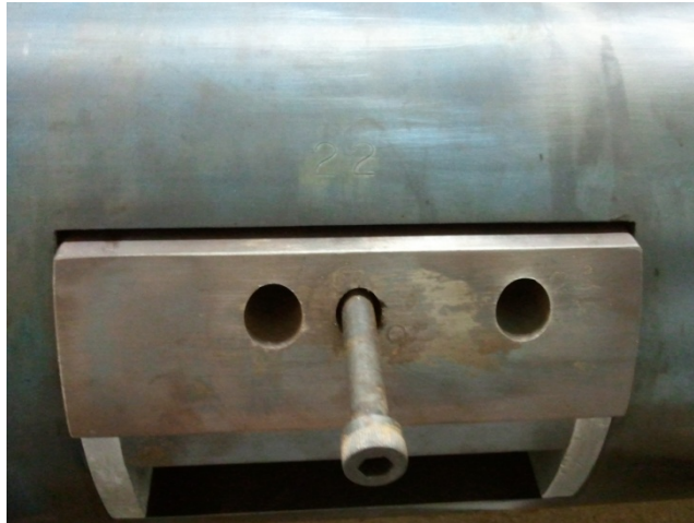
Figure 104: Vis de pression pour démonter la cale de son logement
