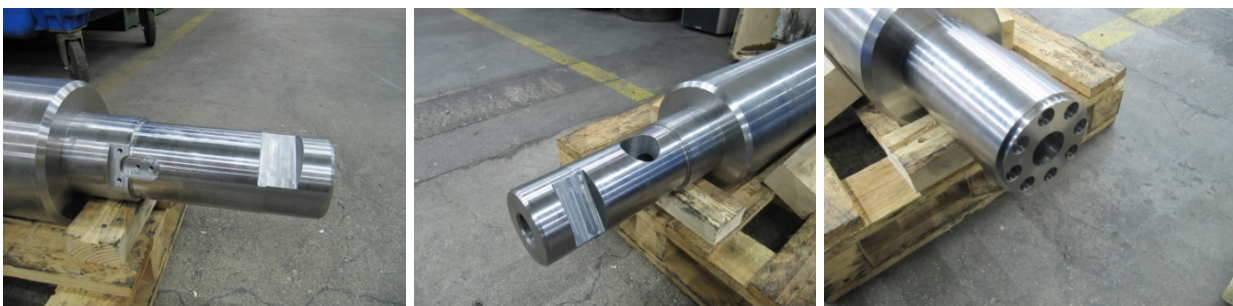
Figure 71 : Extrémités du fourreau à la fin d'usinage
