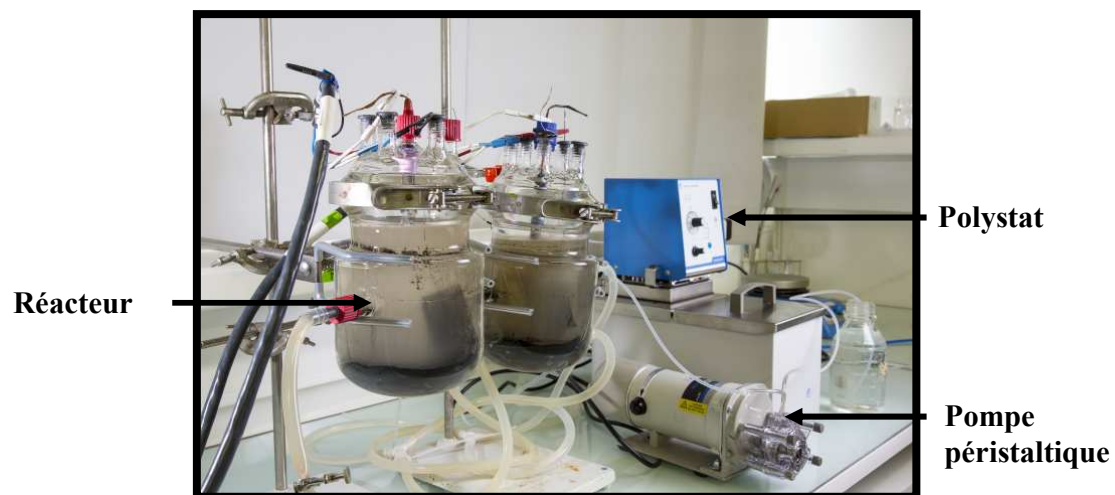
Figure 2.6 : Photographie du dispositif expérimental utilisé lors des essais en continu (Réacteur de 2 nd e génération)
