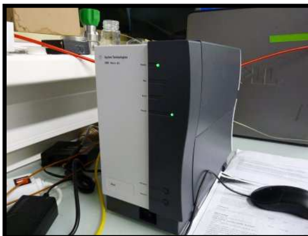
Figure 2.12 : Photographie du chromatographe 490 GC utilisé pour la mesure de composition des gaz de sortie du MEC
