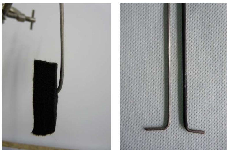
Figure 4.5 : A. Dispositif d'électrode de travail classique avec feutre de graphite connectée par une tige de titane ; B. Tige de titane gainée et non gainée utilisée pour cette expérience
