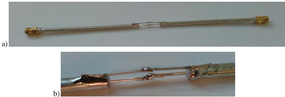
Figure 112 : Photo de deux câbles coaxiaux rigides soudés pour la mesure des pertes de l'excitation, a) vue d'ensemble, b) zoom sur la connexion
