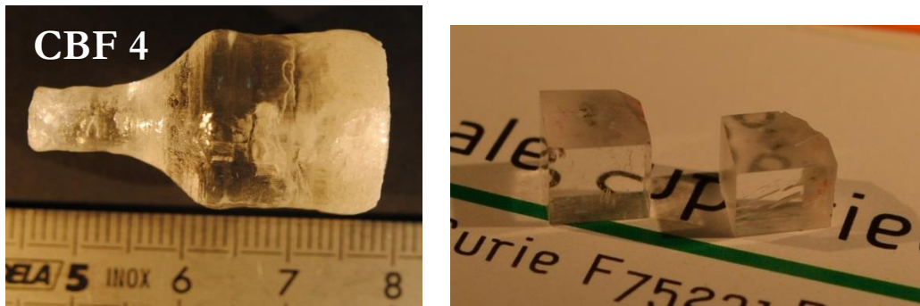
Figure 2.24 : photo du cristal CBF 4 et de deux cubes de dimensions 5 \times 5 \times 5 \text{ mm}^3 taillés pour la GTH à 343 nm en type II.
