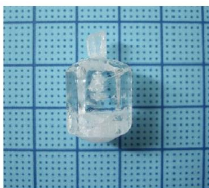
Figure 3.23 : cristal de YAB de dimensions 16 \times 16 \times 18 \text{ mm}^3 synthétisé dans le flux \text{Li}_2\text{O} - \text{B}_2\text{O}_3 [72].
