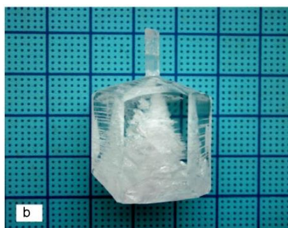
Figure 3.27 : cristal de YAB de dimensions 30 \times 30 \times 25 \text{ mm}^3 obtenu à partir d'un mélange 1 YAB – 3 \text{Al}_2\text{O}_3 - 4,5 \text{ Li}_2\text{O} - 12 \text{ B}_2\text{O}_3 (proportions molaires) [75].
