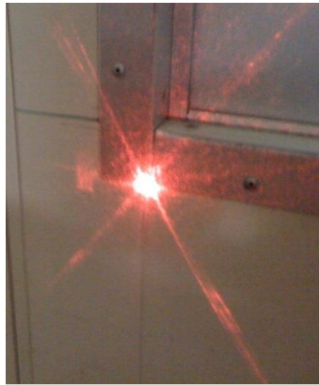
Figure 3.70 : phénomène de diffraction-diffusion observé grâce à un laser He - Ne sur une pièce de YAB taillé à l'accord de phase pour la GSH à 532 nm en type I.
