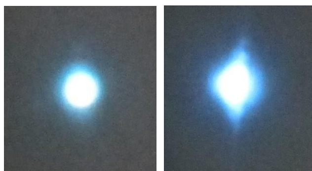
Figure 3.92 : photos de deux faisceaux UV à 266 nm prises à deux positions dans le cristal.
