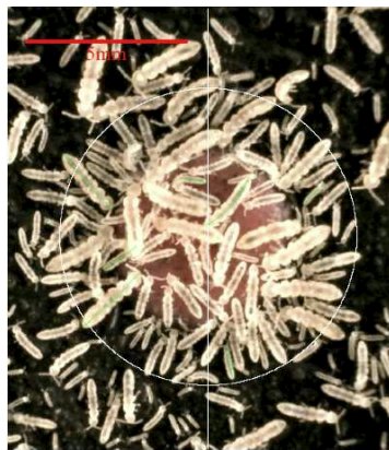
FIGURE 6.3 – Exemple de comptage sur une pastille, les individus inclus dans le cercle sont comptés, partiellement ou totalement à gauche, totalement uniquement à droite. Les lignes vertes montrent le comptage et la mesure de quelques individus.
