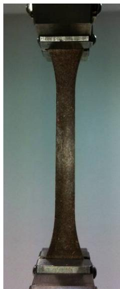
**Figure III.10 : Epreuve de traction PP - chanvre à  $t_0 = 0s$**
