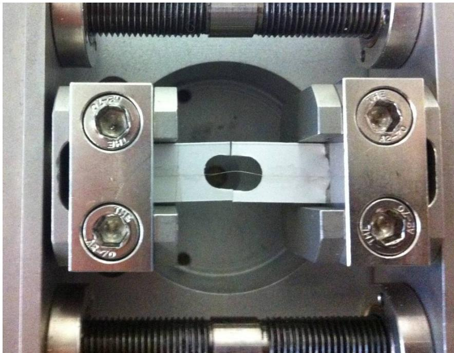
**Figure II.28 : Photographie d'une fibre de chanvre après décharge (déplacement ramené à  $0\mu\text{m}$ )**
