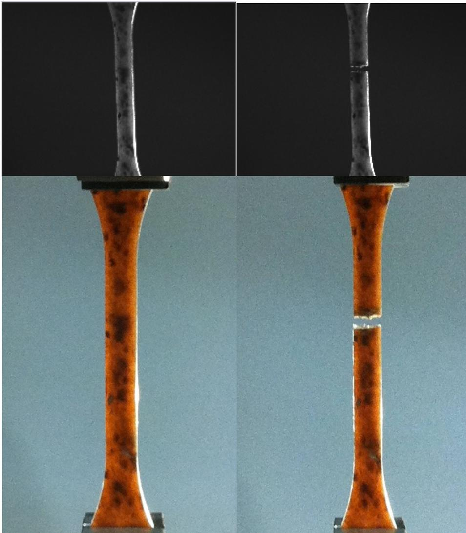
**Figure III.19 : Rupture localisée des composites chanvre – PP**
