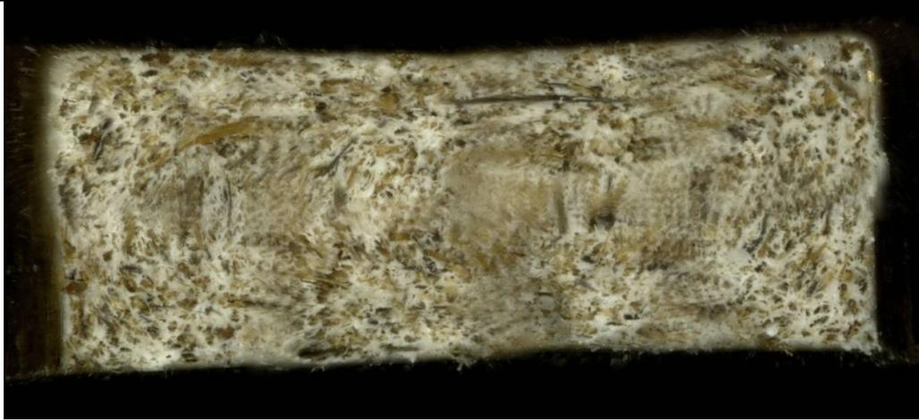
**Figure III.14 : Faciès de rupture homogène d'une éprouvette de traction soumise à de la traction uniaxiale**
