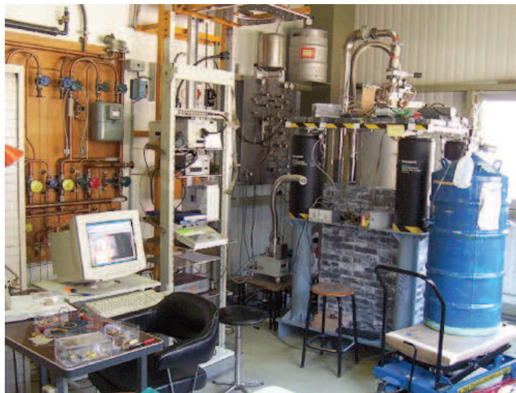
Figure 4.7 – Vue d'ensemble du cryostat à dilution utilisé pour la mesure de échantillons à très basse température. Les problèmes de microphonie sont limités par un système d'amortissement et le bruit de fond environnemental du laboratoire est atténué par un blindage en plomb.
