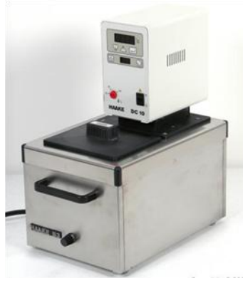
Figure 3-24: Image du bain d'huile thermostaté HAAKE F6-C25
