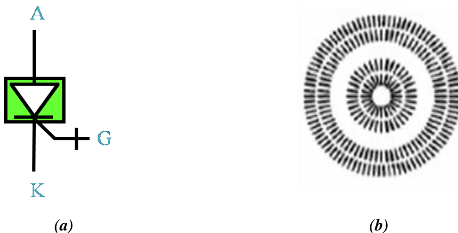
Figure 1-22: Symbole (a) et structure inter-digitée des doigts de cathode du GTO (b)
