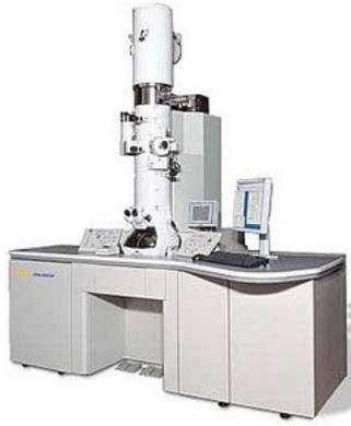
FIGURE 1.5 – Un microscope électronique en transmission JEOL 2100F.
