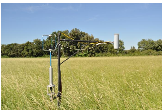
Fig. II.12 Appareil de mesure de l'eddycovariance de l'INRA
