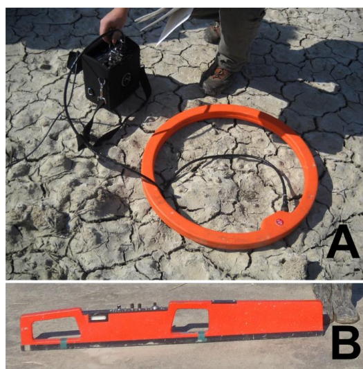
Fig. II.8 Equipements électromagnétiques utilisés sur le terrain A) EM 34-3 et B) EM38
