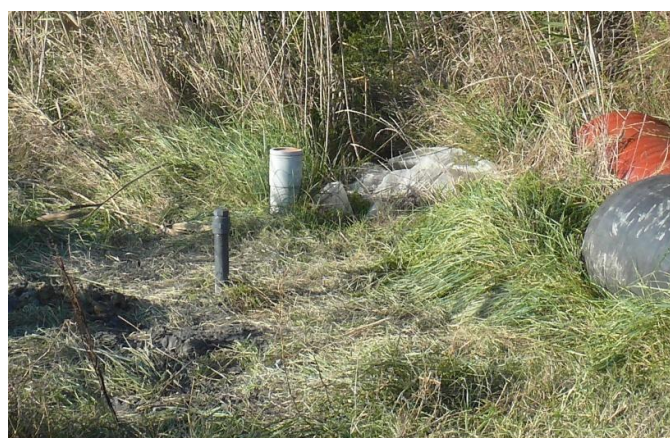
Fig. II.3 Exemple de piézomètres installés dans la zone d'étude
