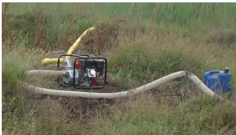
Fig. II.10 Pompe de surface utilisée pour les essais de pompages
