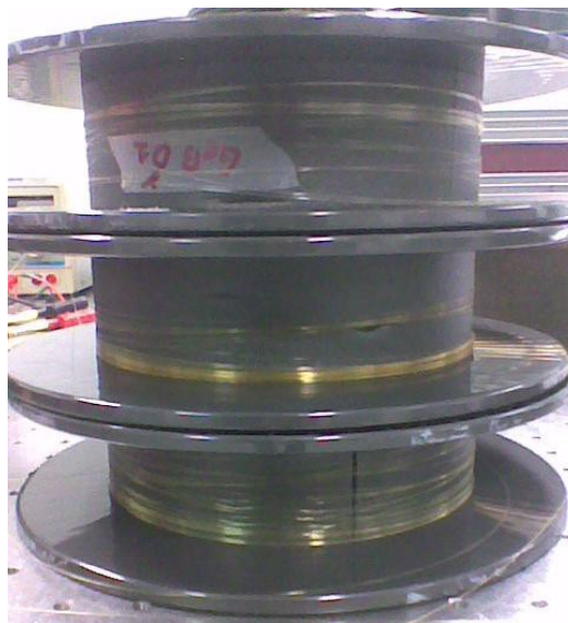
Figure I-18. Influence des radiations sur la coloration du revêtement des fibres optiques en acrylate
