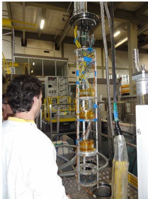
Figure I-18. Disposition des échantillons sur les paliers en fonction du débit de dose visé particulier durant l'irradiation. Les performances de ces échantillons (en termes de RIA et RIBS)
