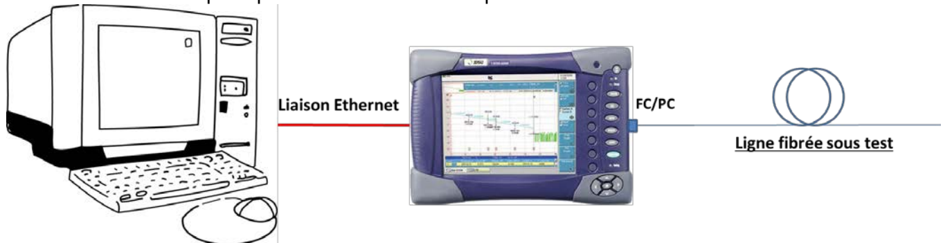
Figure I-4. Réflectromètre optique contrôlé par Labview
