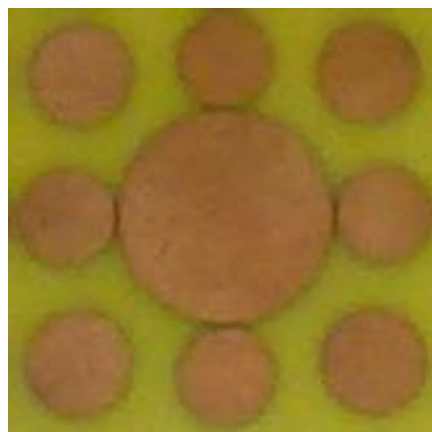
Figure 3.19 - Photo d'une cellule unité du prototype d'absorbant à métamatériaux de type MultiPatches
