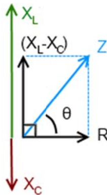
Kuva 8. Impedanssin muodostuminen ja vaihekulma.
