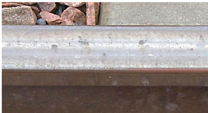
Kuva 29. Käytetyn kiskon hamarassa olevia jälkiä.
