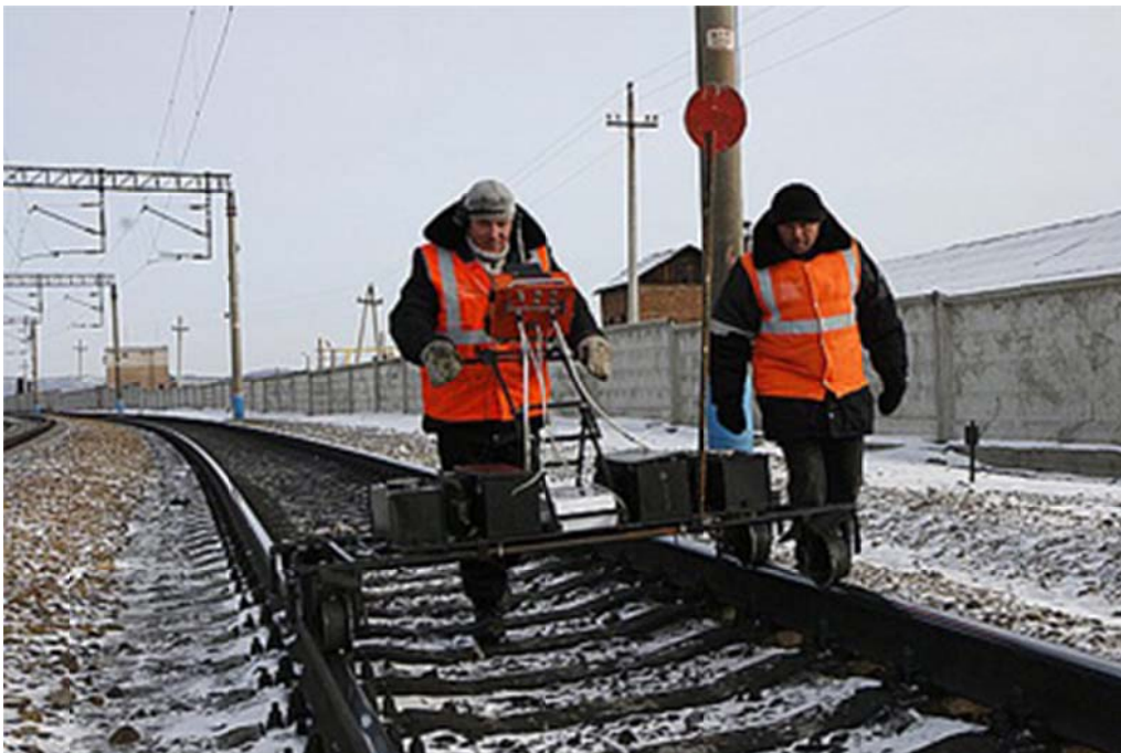
Kuva 1. Kiskon pyörrevirtatarkastus Venäjällä (Railway company PUTEETS 2013).
