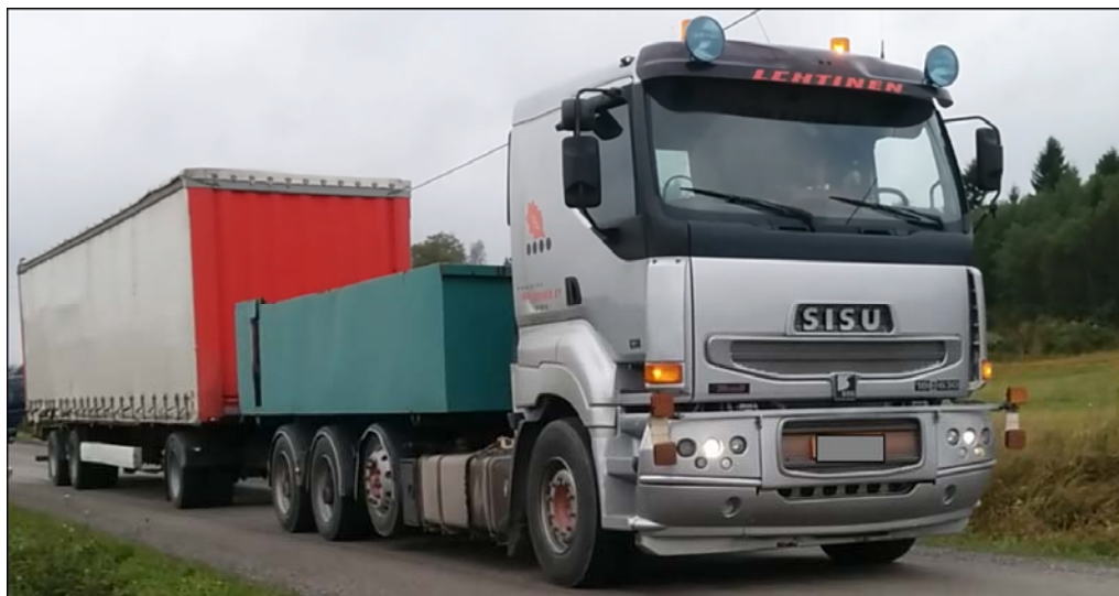
Kuva 3.5 Kuormituskokeissa käytetty ajoneuvo. Ajoneuvon kokonaismassa oli 56,5 t, joka jakaantui akseleille seuraavasti: etuakseli 7,5 t, vetoauton teliakselit yhteensä 21 t, perävaunun ensimmäinen akseli 10 t ja perävaunun teliakselit yhteensä 18 t
