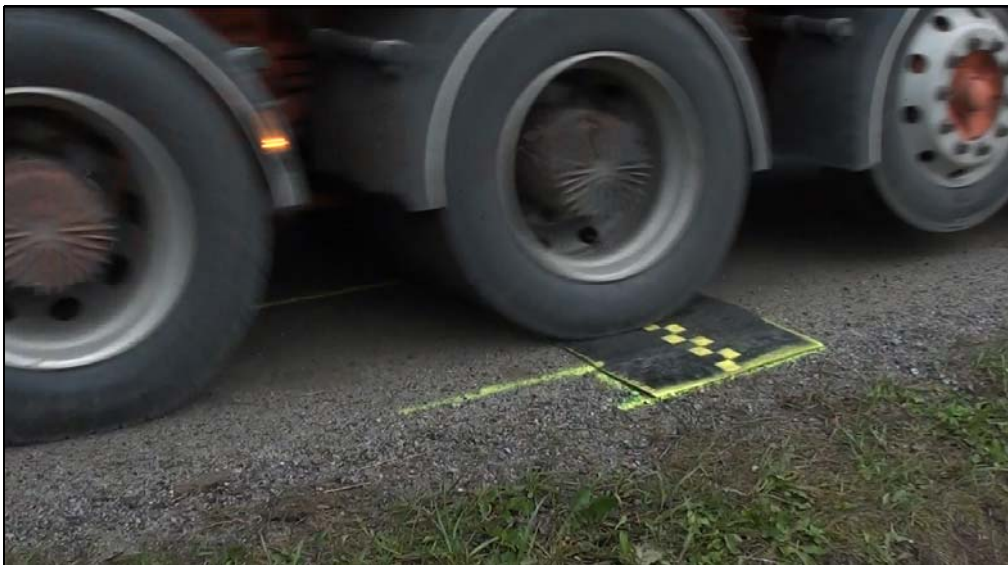
Kuva 3.4 Kuormitusajoneuvo ylittää mittauskohdan. Muovimattoon on maalattu ruutulippukuviota, joka koostuu 50*50 mm alueista. Kun tiedetään maton reunan sijainti suhteessa mittaasantureihin, voidaan laskea jokaisen rumpua kuormittavan renkaan etäisyys suhteessa rummussa oleviin antureihin.
