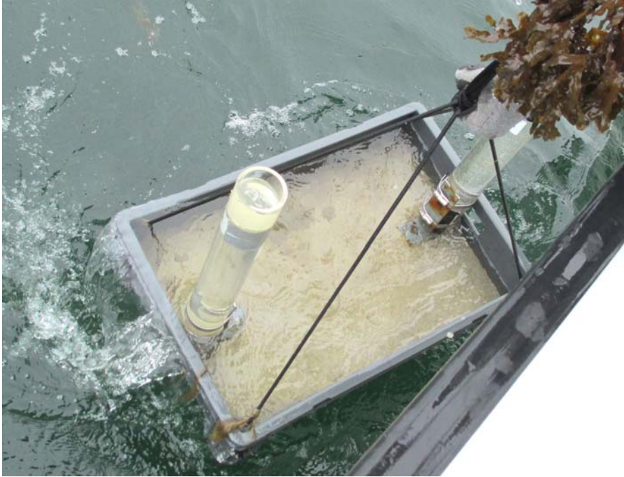
Kuva 7. Sedimenttikeräimen nosto ensimmäisen mittausjakson jälkeen 26.5.2014. Kuvassa näkyy kaksi keräinputkea painolaatikossa (Kuva: Merilin Vartia).
