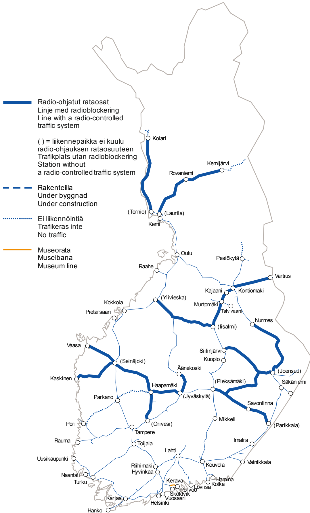
Bild 4. Banavsnitt med radiostyrning.
