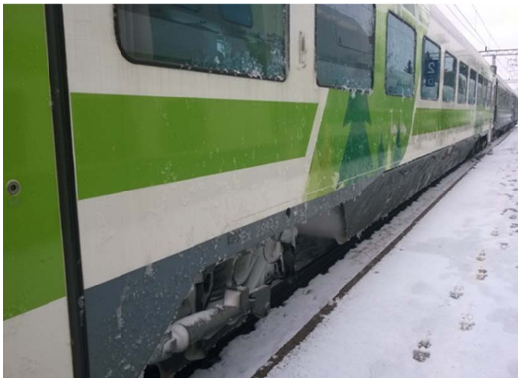
Kuva 36. Jäätä junan rakenteissa Kajaanissa 30.3.2015.
