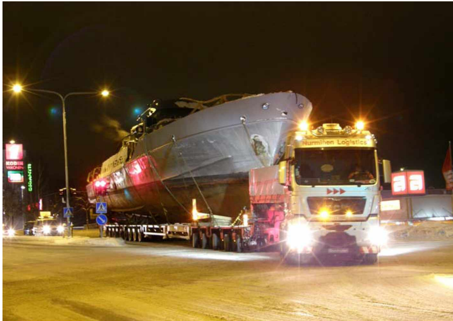
Kuva 6. Esimerkki suuresta erikoiskuljetuksesta tieverkolla: Vartiovene 55 siirrettiin Näsijärveltä Itämerelle tammikuussa 2012. Tiekuljetus tapahtui Tampereelta pääasiassa valtatieä 11 pitkin Poriin, mistä alus jatkoi matkaansa meritse Helsinkiin (kuva: Kimmo Heikkilä 2012).
