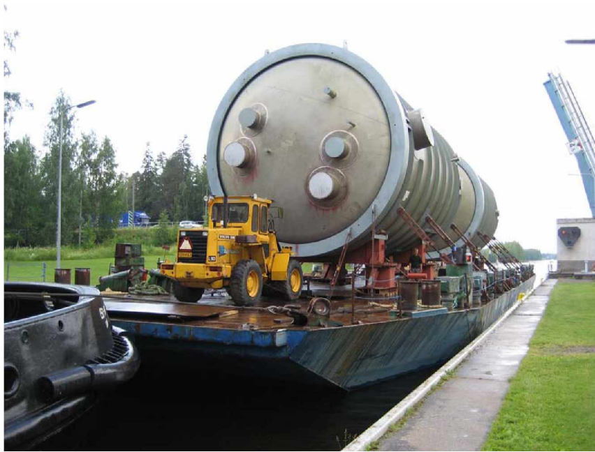
Kuva 8. Sisävesikuljetusten mittoja rajoittavat pääasiassa sulkulaitteistojen rakenteet (kuva: Mika Pikkuharju 2006).
