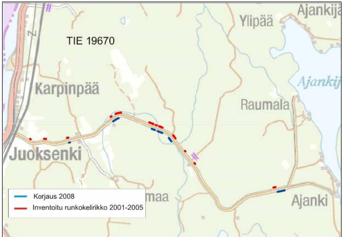
Kuva 17. Tielle tehdyt toimenpiteet sekä tiellä inventoidut runkokelirikkokohdat
