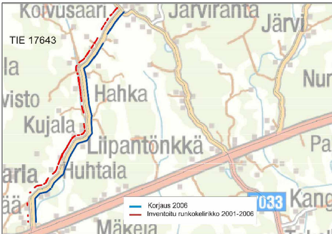
Kuva 14. Tielle tehdyt toimenpiteet sekä tiellä inventoidut runkokelirikkokohdat vuosina 2001–2006
