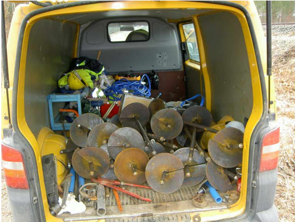
Kuva 4. Kierrettäviä painumamittareita (Destia Oy)
