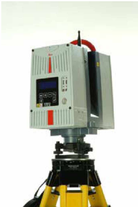
Kuva 19. HDS6100-laserkeilain (Leica Geosystems 2010a)
