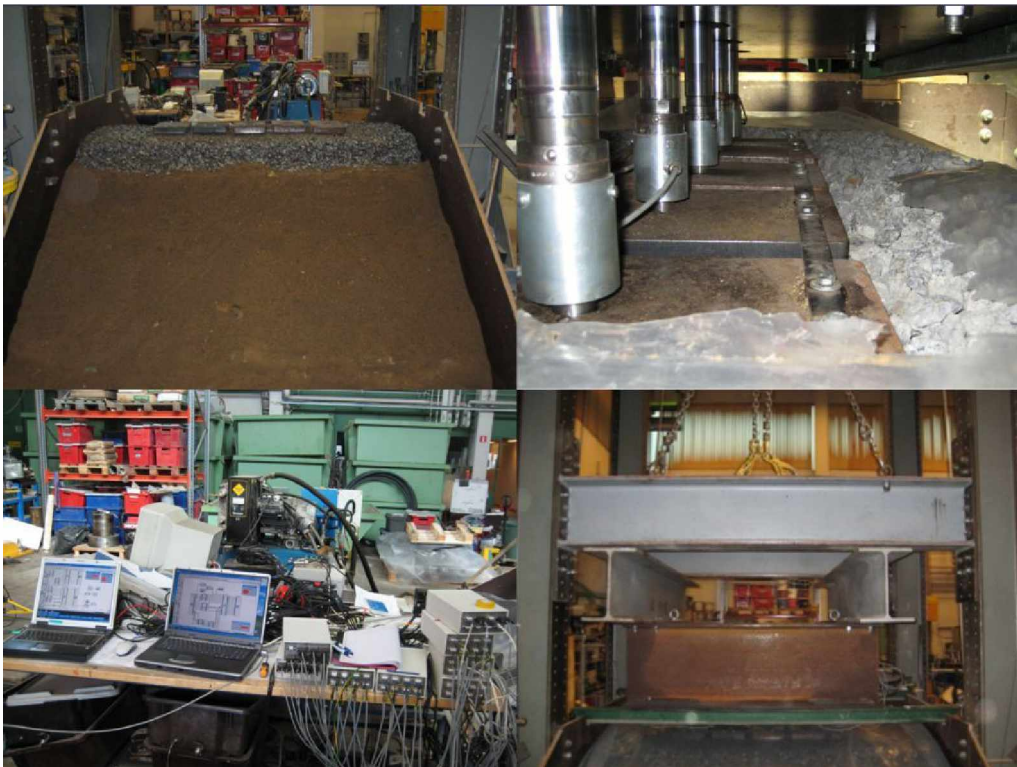
Kuva 5.1 Kuormitussarjojen koejärjestely. Vasemmalla ylhäällä: lopulliseen korkeuteensa rakennettu koepenger sekä ratapölkkyjä simuloineet teräslevyt. Vasemmalla alhaalla: etualalla mittauskalusto, takana kuormitus-sylintereiden hydraulikkajärjestelmä. Oikealla ylhäällä: Penkereet kuormitettiin viidellä hydraulisylinterillä liikkuvan junakuorman vaikutusta simuloivasti. Oikealla alhaalla: Kuormitusjärjestelyä varten asennettu teräspalkisto.
