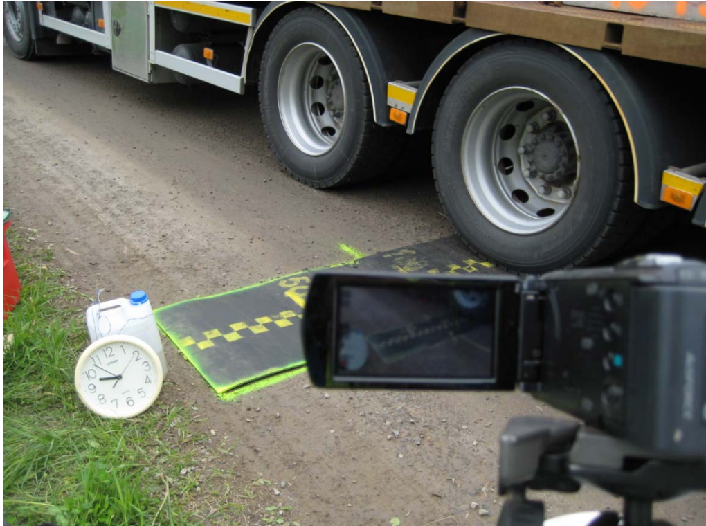
Kuva 3.4 Ajoneuvon ajolinjan mittaamisen periaate. Tielle on asetettu kumimatto, jossa ruutulippukuviointi. Videokameralla tallennetaan jokainen ylitys, ja videokuvasta saadaan selville jokaisen renkaan sijainti antureiden suhteen.
