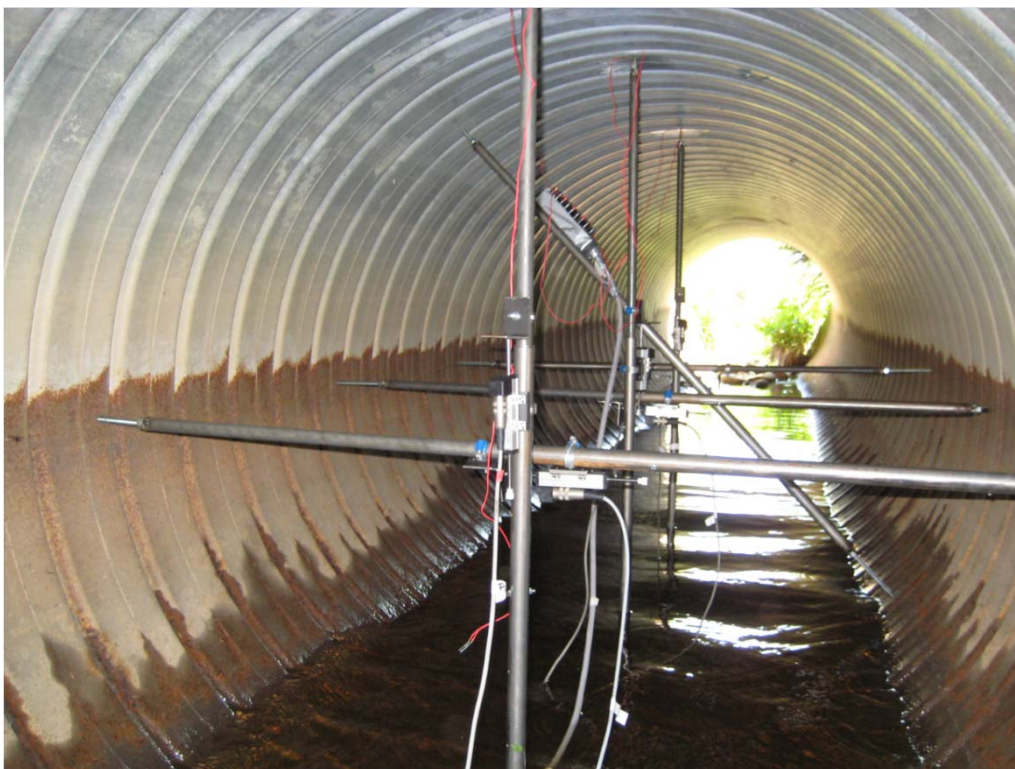
Kuva 3.1 Teräsrumpu ( \varnothing=1400 mm) instrumentoituna. Anturit on asennettu kolmeen poikkileikkaukseen, jotka sijaitsevat noin 900 mm etäisyydellä toisistaan. Jokaisesta poikkileikkauksesta mitataan rummun halkaisijan muutosta pysty- ja vaakasuunnassa sekä rummun laen venymää.
