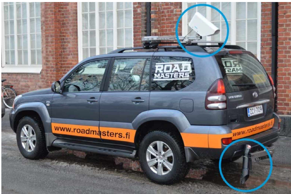
Kuva 1. Optinen kitkamittari DSP310 (ylemmän ympyrän sisällä) tarkkailee tien pintaa etäämmältä, joten kyseinen mittari kiinnitetään ajoneuvon katto- telineille. Optinen kitkamittari RCM411 (alemmän ympyrän sisällä) tarkkailee tien pintaa lähempää, joten se kiinnitetään ajoneuvon perä- koukkuun. Kummatkin mittarit on kohdistettu ajoneuvon vasemmanpuoleiseen pyöränuraan.
