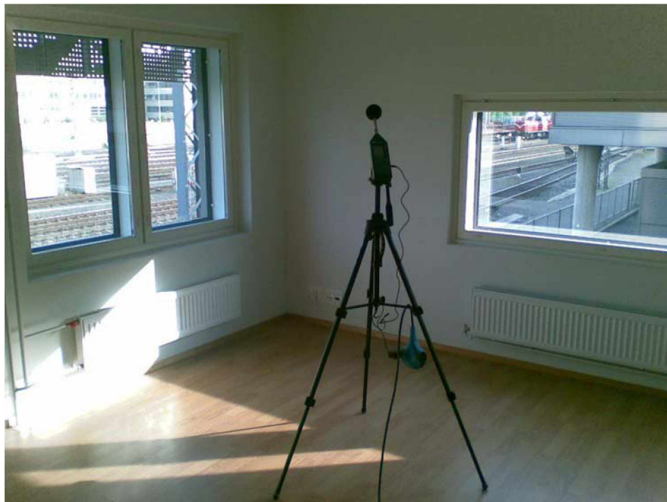
Kuva 6.3.1 Ääneneristävyyden mittausta asuintalossa
