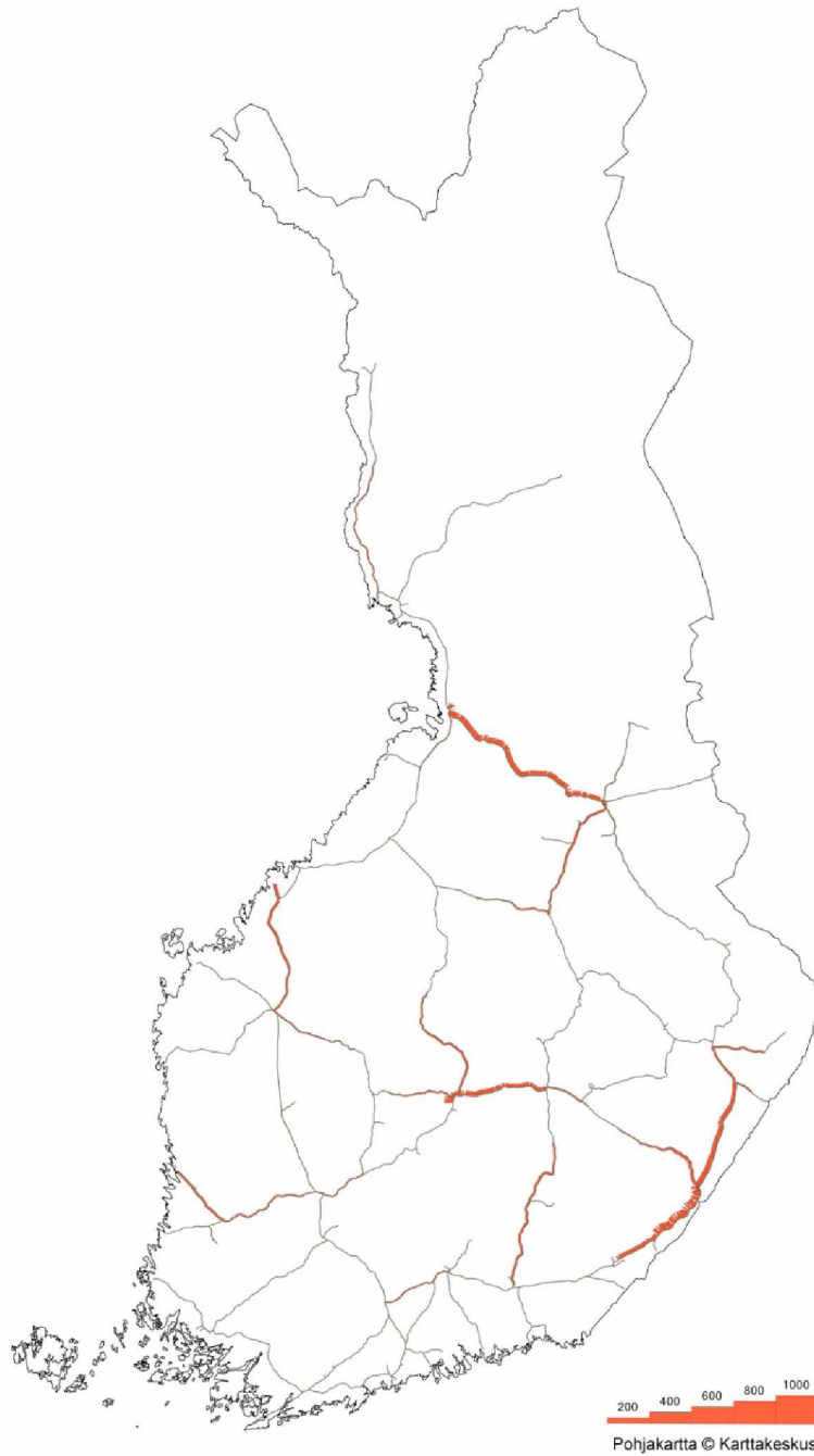
Kuva 8. Energiapuun kuljetusten aiheuttama rataverkon kuormitus (1000 netto-tonnia/vuosi) perusskenaarion mukaisessa valtakunnallisessa optimi-tilanteessa. Tarkastelu ei sisällä mahdollisten biopolttoainelaitosten kuljetuksia.
