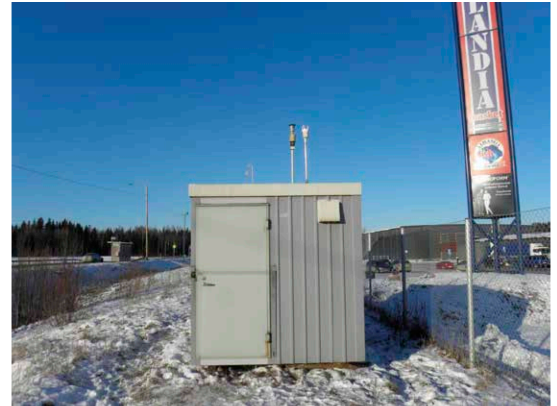
Kuva 3.2. Nuijamaan ilmanlaadun mittausasema.
