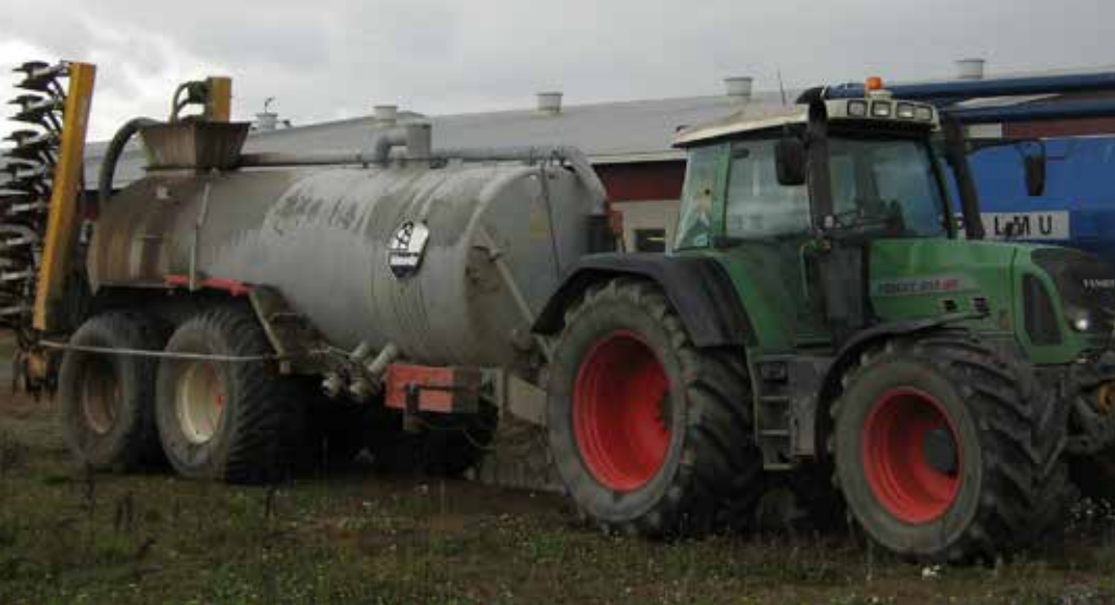
Sijoittava lannanlevitysvaunu. Kuva: Sweco Ympäristö Oy
