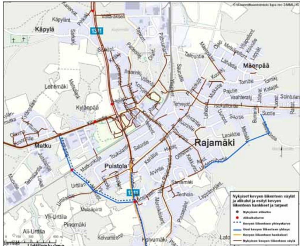
Kuva 23. Rajamäellä sijaitsevat nykyiset kevyen liikenteen väylät ja alikulut sekä suunnitelmassa esitetyt uudet hankkeet sekä yhteys- ja alikulutarpeet. (Lähde: Nurmijärven kevyen liikenteen verkoston ja ulkoilureitistön suunnitelma 2010)
