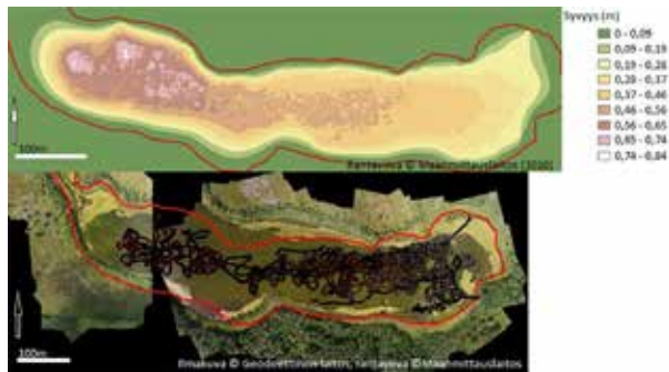
Kuva 15. Käringsundin syvyyskartta ja syvyyspisteet ilmakuvassa. Syvyyspisteitä on mitattu tiheämmin pohjois- ja itäosissa. Rantaviiva ja syvyyskäyrät eivät täsmää ilmakuvan kanssa.
