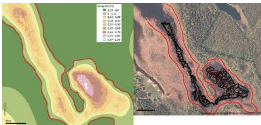
Kuva 16. Kunnottomanperukan syvyyskartta ja syvyyspisteet ilmakuvassa. Syvyyspisteitä on tiheästi, sillä suurin osa fladasta kartoitettiin kahlaten. Syvyyskartan rantaviiva on piirretty mukaan Maanmittauslaitoksen Maastotietokannan rantaviivaa (2010).
