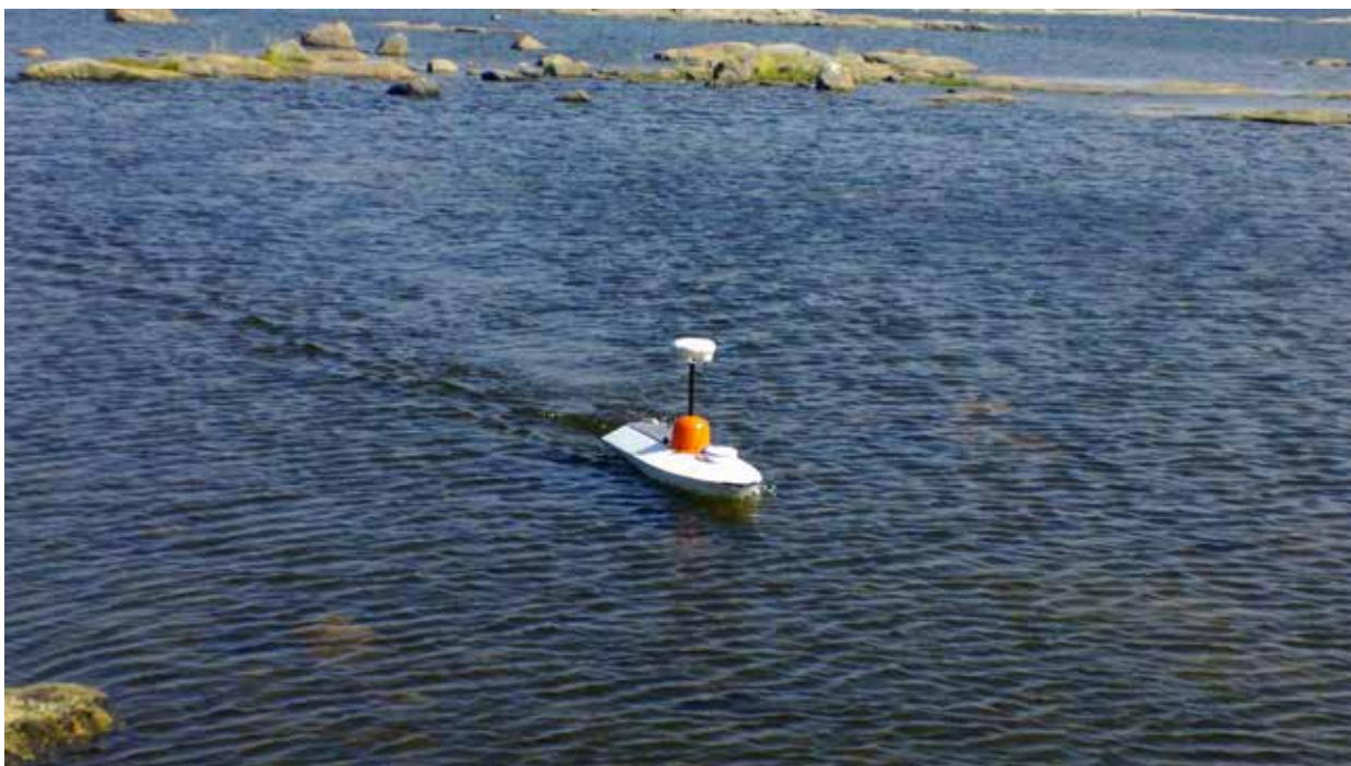
Kuva 7. Syvyyskartoitusta kauko-ohjattavalla veneellä. ADCP:n dGPS-vastaanotin on sijoitettu veneen keulaan. VRS-GPS-vaastanotin on tangon päässä, joka on kiinnitetty ADCP-mittariin (oranssin kuvun alla). Kuva: Milja Norja
