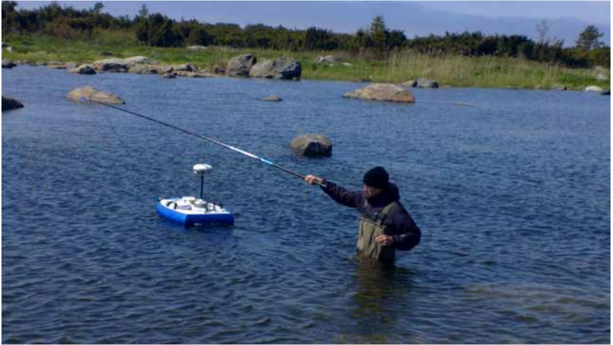
Kuva 8. Kaikuluotain, dGPS ja VRS-GPS kiinnitettynä kelluvaan mittaustaivaan. Kuva: Milja Norja
