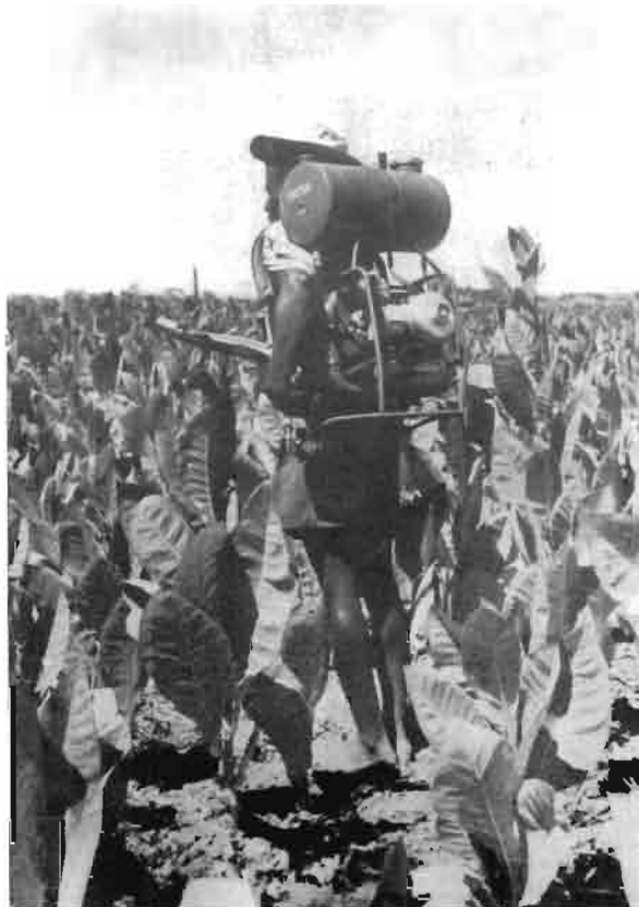
Atomiseur portatif pour traitements par nébulisation à faible volume d'eau.
