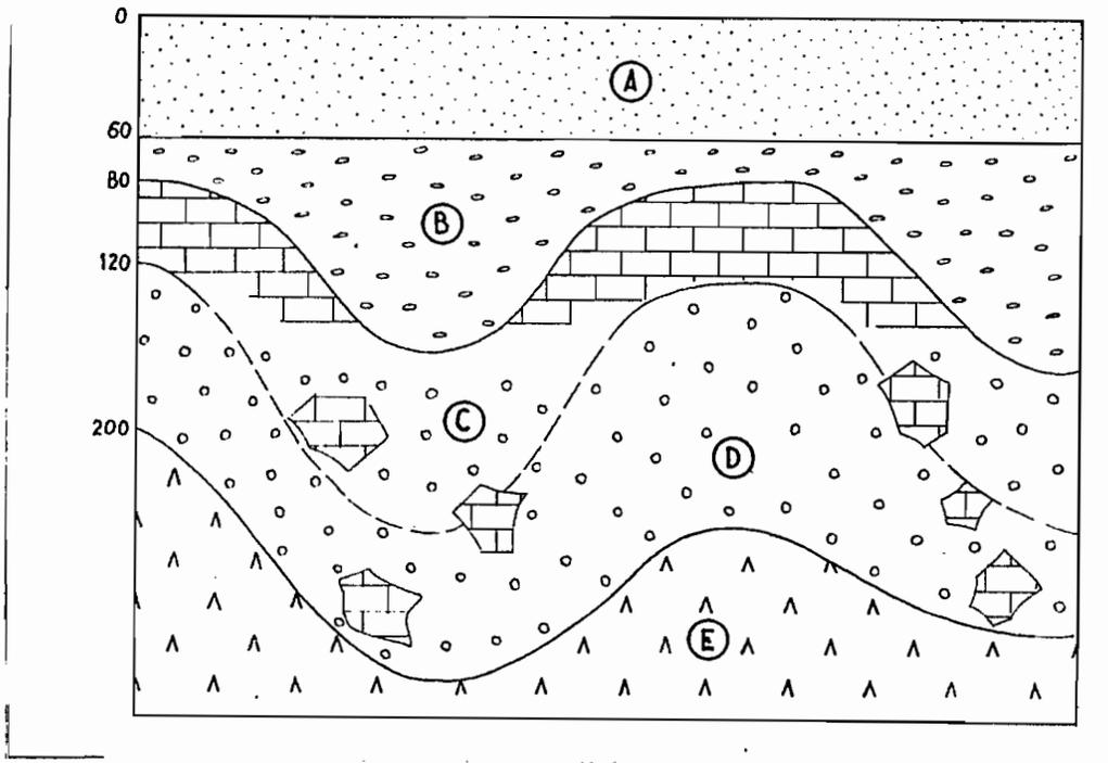
A - Alluvions sablo-limoneuses - brun, éclairci par de fines concrétions blanches - particulaire serré avec glaçage en surface.
