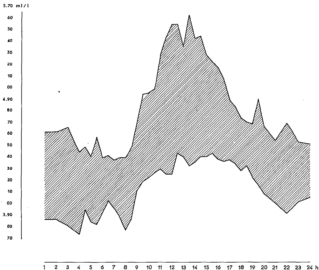
Fig. 3. — Variations, au cours de 24 heures, des écarts entre les valeurs extrêmes (minima et maxima) des teneurs en O_2 dissous.
