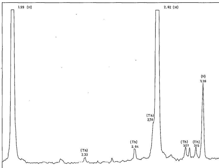
FIG. 3. — Diffractogramme X de la dalle saline.
