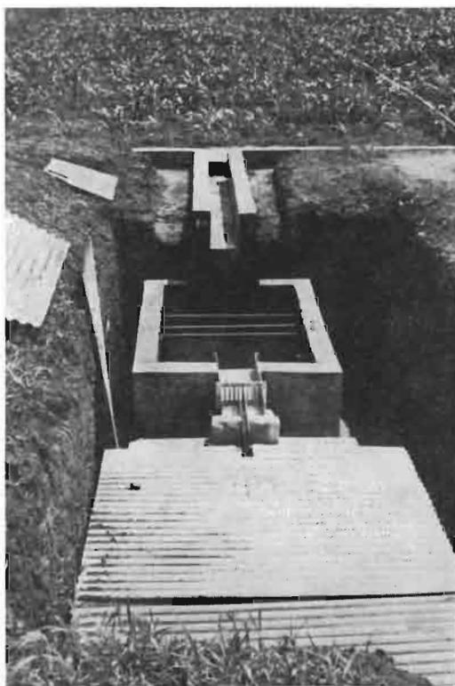
Fig. 15. — Essai d'érosion, parcelle 5.
