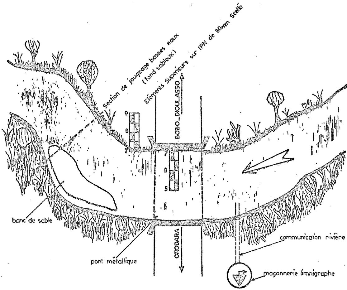
Une échelle limnimétrique type ORSTOM, en quatre éléments de un mètre était également installée à la même date, sur les fers IPN existants redressés :
