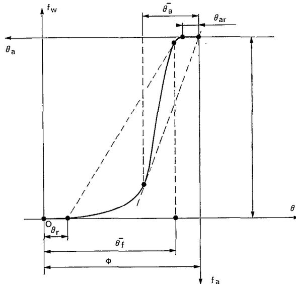
Fig. 2. — Courbes  $f$  et  $f_a$  en fonction de  $O$  et  $O_a$ . Construction graphique de Welge pour obtenir les valeurs amont des fronts d'eau et d'air
