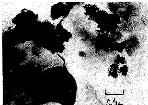
PHOTO 2. — Observations au microscope électronique à transmission. Echantillon L T 5 - Microscopie électronique, G : 120.000 - Amas de grains noirs d'hématite.
