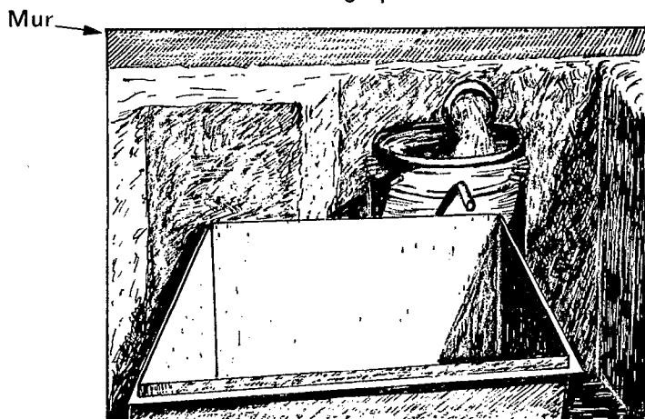
B. Case d'érosion avec fût piège à sédiments partiteur et 2ème cuve de stockage gouttières plastifiées
