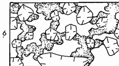
microstructure spongieuse réticulée
