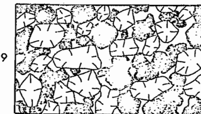
microstructure d'entassement libre
