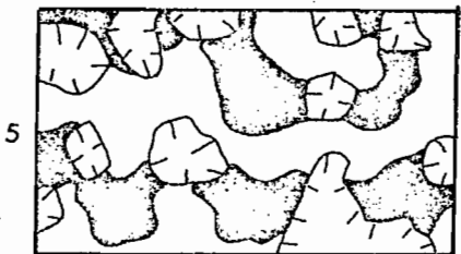
microstructure spongieuse en chaînes
