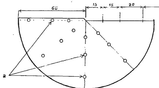
FIG. 2. — Découpage cône supérieur plastique au 1/20<sup>e</sup>
