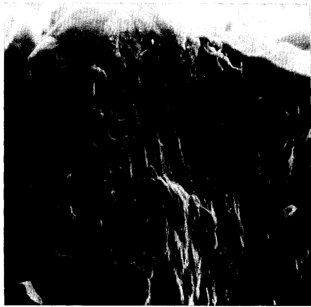
PHOTO 8. — DIM 10 bis. Quartz NU. Figures triangulaires de dissolution à la surface du grain de quartz ( \times 350 ).
