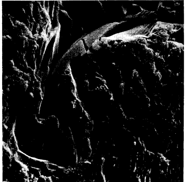
PHOTO 10. — DIM 10 bis. Même grain que photo 9. Marques de chocs profondes, en coups d'ongles. Quelques figures triangulaires de dissolution sur les faces lisses de la cassure ( \times 800 ).
