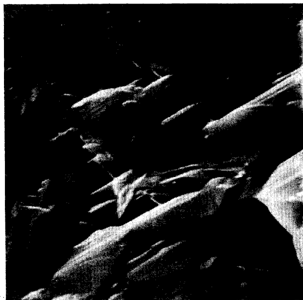
PHOTO 7. — DIM 10 bis. Quartz NU. Figures de dissolution en V et figures en V agrandies en figures triangulaires de dissolution ( \times 4\ 000 ).
