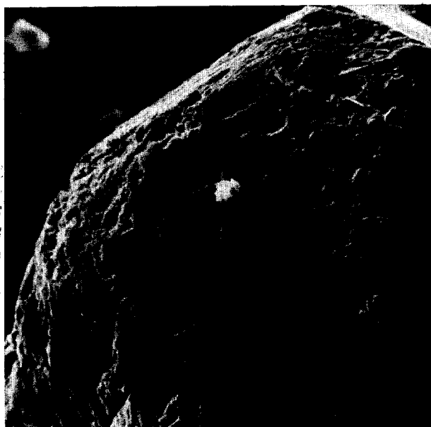
PHOTO 5. — DIM 6 — Quartz à coins arrondis et arêtes émoussées. Aspect picoté mat par juxtaposition de marques de chocs en V et en coups d'ongle ( \times 800 ).
