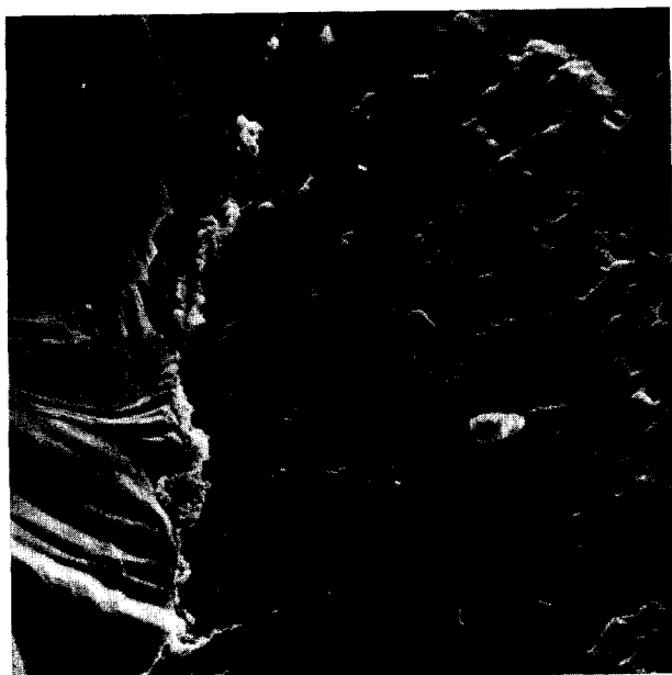
PHOTO 1. — DIM 6 — Quartz NU. A gauche: face lisse cassure fraîche, escaliers et stries structurales ; à droite figures de dissolution en V, orientées dans le même sens, sur une face revêtue d'une pellicule de silice amorphe ( \times 800 ).
