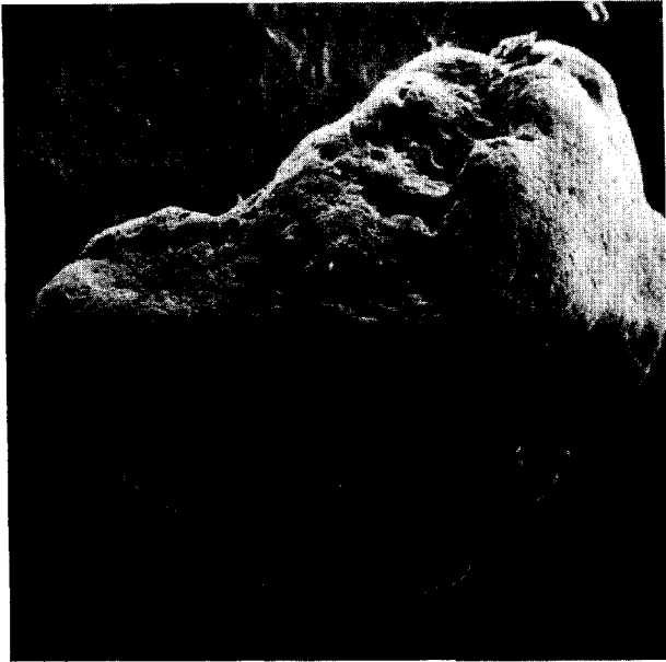
PHOTO 9. — DIM 10 bis. Quartz arrondi mat Marques de chocs très serrées ( \times 50 ).
