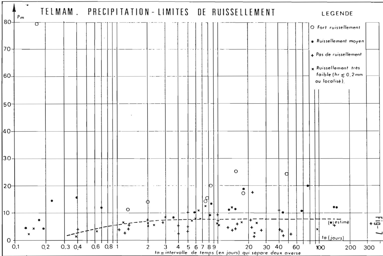
Pour des précipitations inférieures à 7,5 mm, on a pu constater dans certaines conditions un ruissellement localisé à l'exutoire du bassin.
