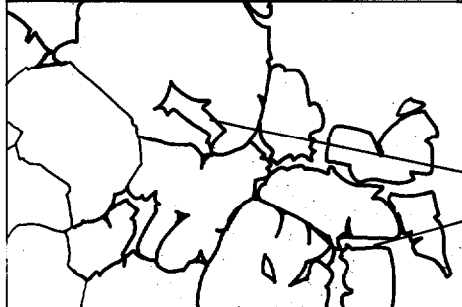
Photo 13 - Gx156 - Echant. AUY 1 - XPL Zone externe, grains disjoints et corrodés Alvéoles de dissolution Films d'oxyde entre les grains disjoints
