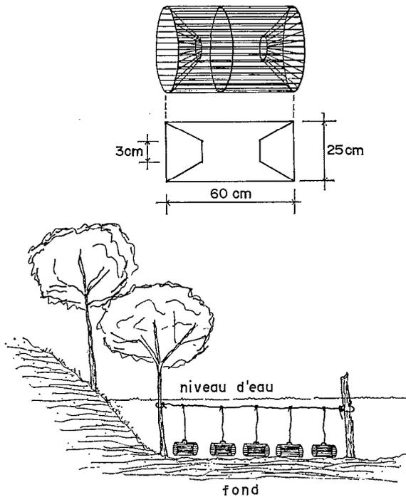
FIG. 2. — Casier à crevette utilisé dans le Para, Brésil
